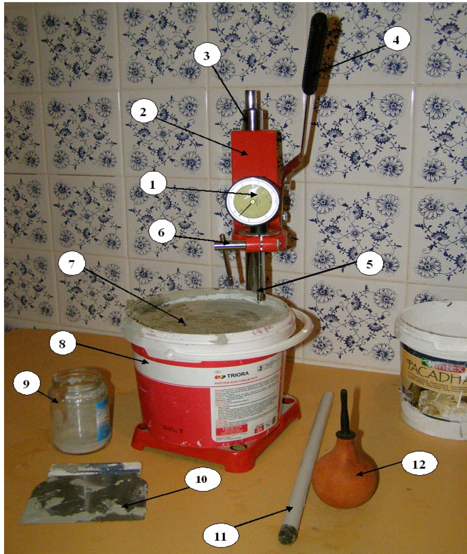
Рисунок 3.8 – Лабораторний стенд для виміру пластичної міцності бетонної суміші до 50 \text{ кг/см}^2 :
