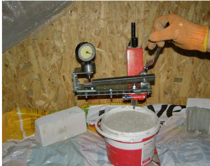
Рисунок 3.9 – Лабораторний стенд для виміру пластичної міцності бетонної суміші із пристроєм для розширення діапазону вимірів до 300 \text{ кг/см}^2
