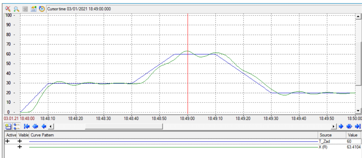
Рисунок 4.32 – Перехідний процес з налаштуваннями K_p = 0.04 та K_i = 0.005
