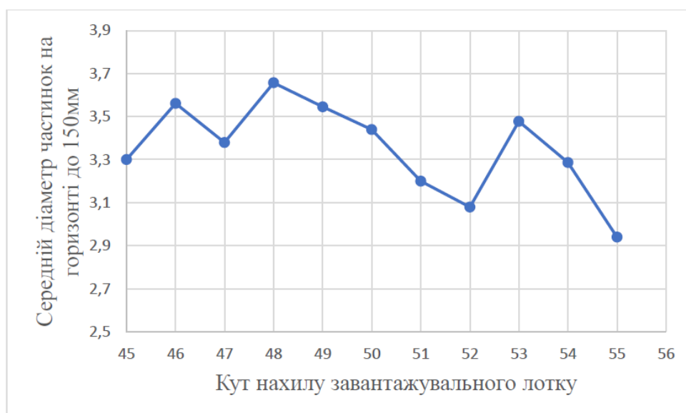
Рисунок 4.10 - Залежність середнього діаметру частинок шихти на першому горизонті в діапазоні від 0 м до 0,15 м від кута нахилу завантажувального лотка
