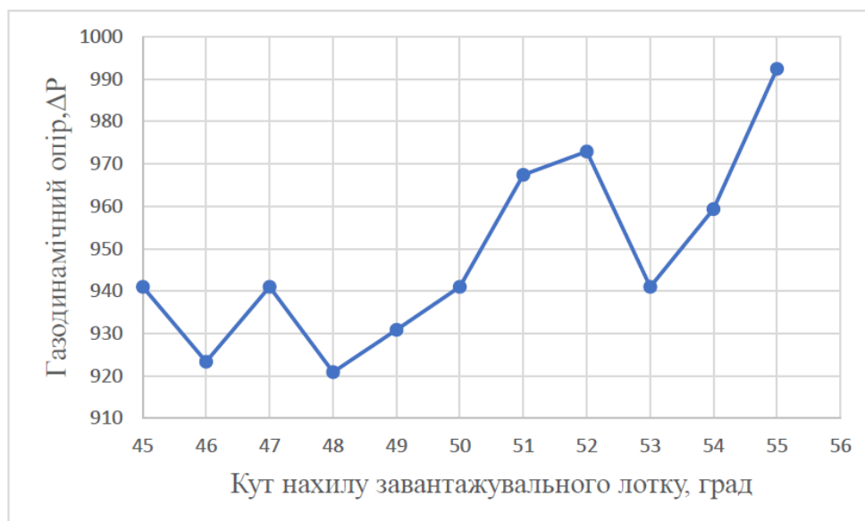
Рисунок 4.16 - Залежність газодинамічного опору від кута нахилу завантажувального лотку
