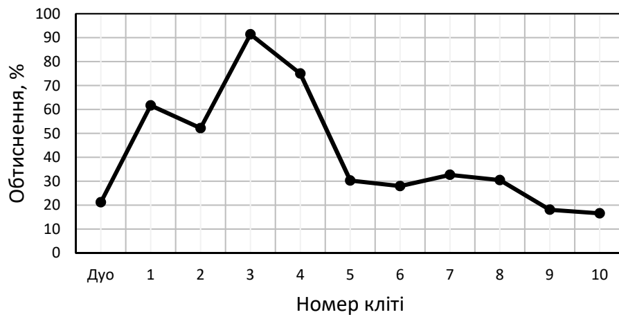
Рисунок 2.13 – Енергосилові параметри прокатки на стані 1680
