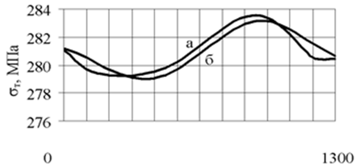
Рисунок 3.6 - Розподіл межі плинності по ширині штаби розраховані (а) і виміряні (б).
