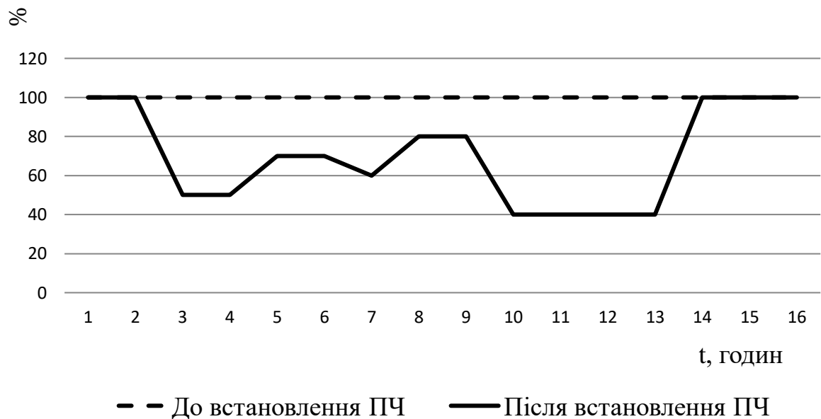
Рисунок 3.5 – Графік зміни навантаження електричного двигуна
