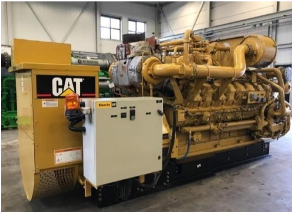
Рисунок 2.1 – Загальний вигляд газопоршневої генераторної установки G 3406 LE -190 фірми «Caterpillar»
