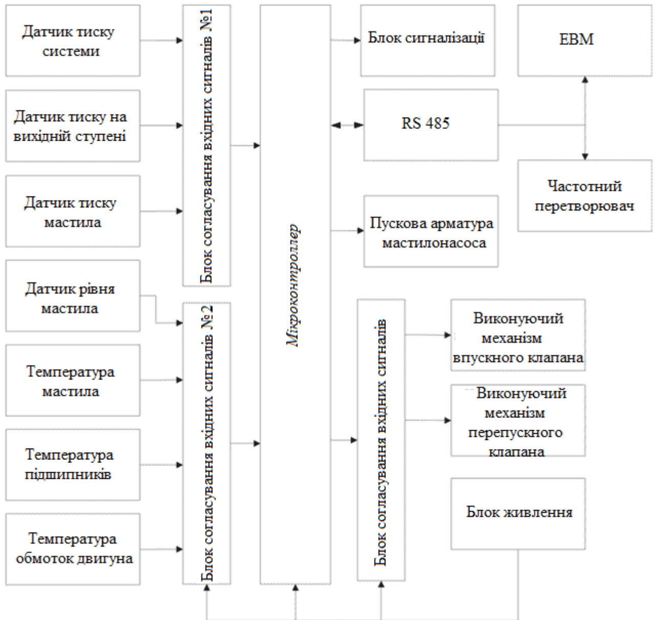
Рисунок 2.6 – Модернізована схема управління компресором
