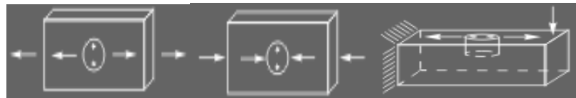
Розтяжіння Стискання Вигин, розтягання
