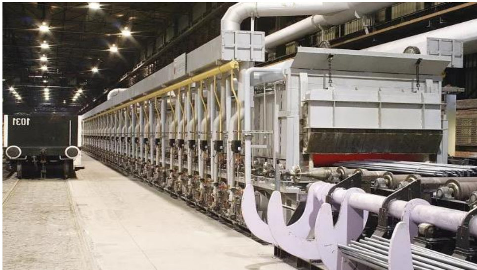
Рисунок 1.5. Загальний вигляд методичної печі
