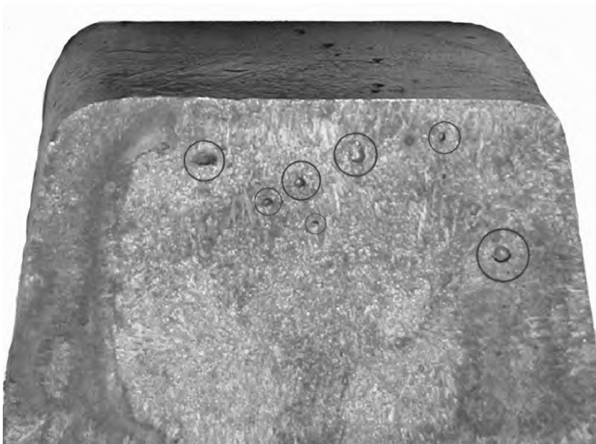
Рисунок 3.1 – Дефекти внутрішньої структури в бруску трапецієподібного перерізу, який отриманий на роторній МБЛЗ
