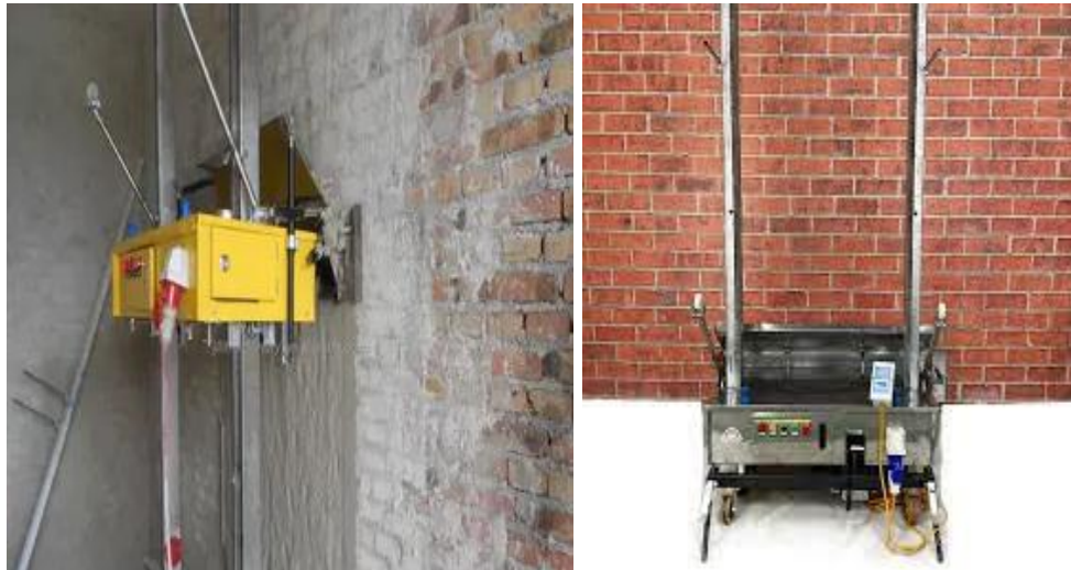
Рисунок 1.18 – Самостійна установка яка наносять штукатурку на стіну
