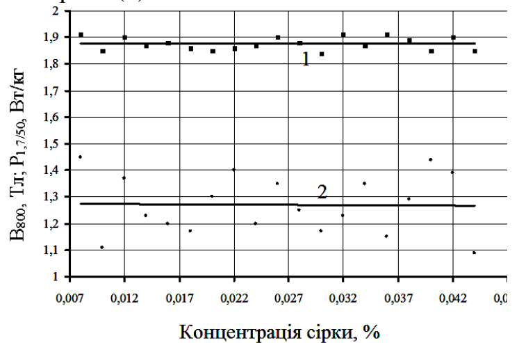
Рисунок 12 - Вплив вмісту сірки на магнітні властивості сталі
