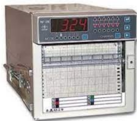
Рисунок 3.3 – Загальний вигляд паперового реєстратора РМТ-49D РМТ мають наступні характеристики:
