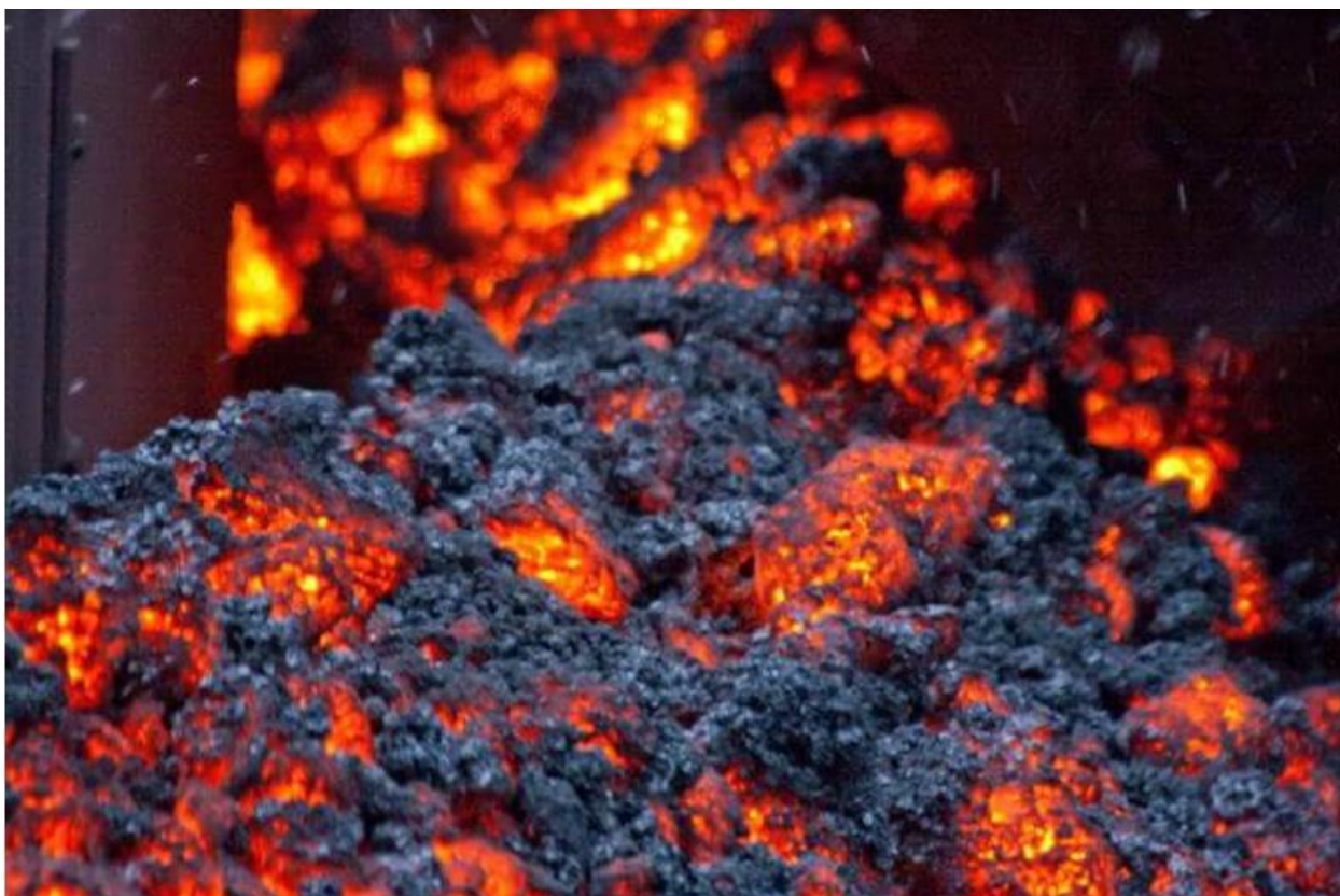
Рисунок 1.4 – Шихта для доменної плавки: агломерат [1]
