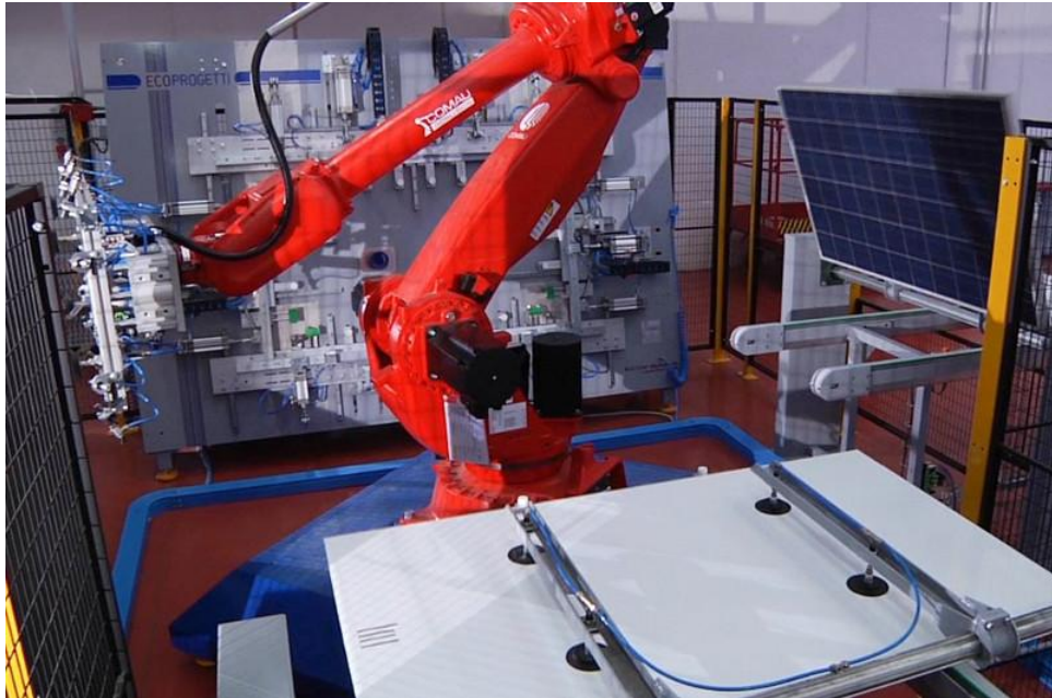
Рисунок 1.9 – Монтаж рами, з'єднувальної коробки і контактів
