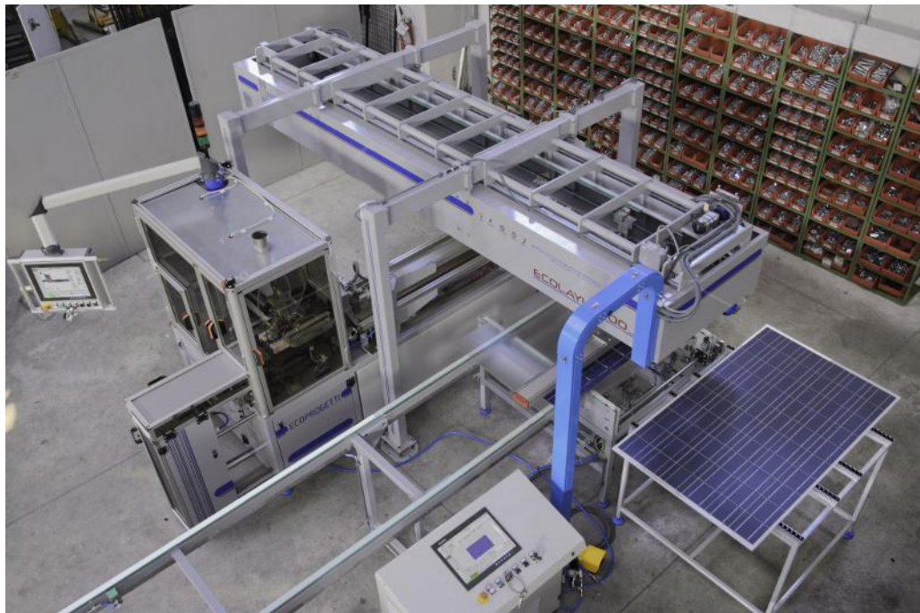
Рисунок 1.7 - Тестування на відсутність розривів електричного кола
