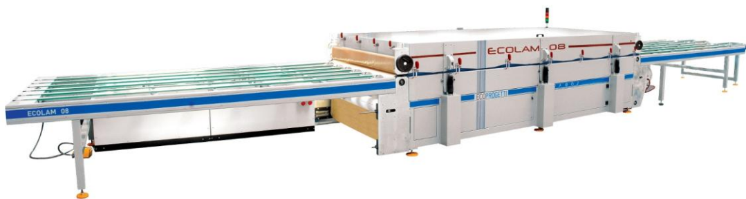
Рисунок 1.8 - Герметизація при високій температурі і надмірному тиску
