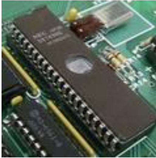
Рисунок 1.10 – Мікроконтролер 8749, який має вбудовану пам'ять EPROM
