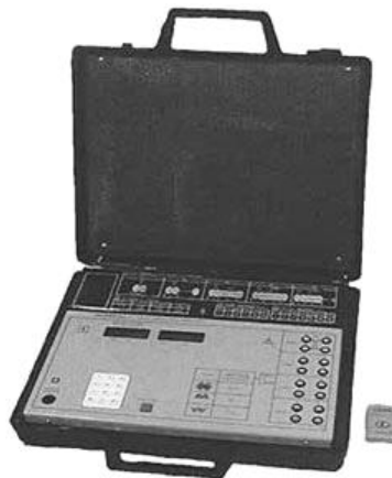
Рисунок 1.3– Зовнішній вигляд апарата для терапії з модульованими синусоїдальними струмами "Ампліпульс-7"[6].
