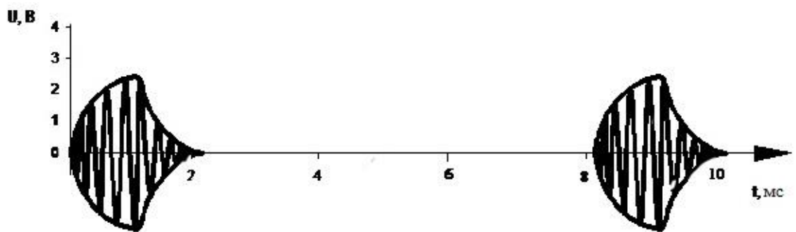
Рисунок 2.16 - Вихідна напруги з електростимулятора
