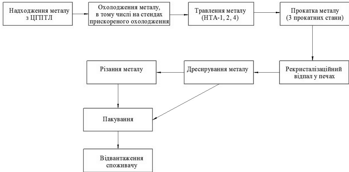
Рисунок 1.5 – Технологічна схема виробництва цеху
