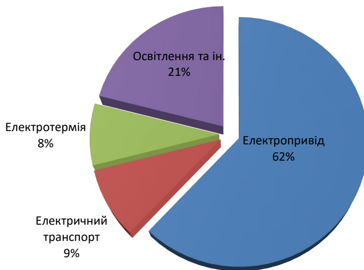
Рисунок 1.1 – Діаграма співвідношення електроенергоспоживання обладнання ТОВ «ЗТМК»
