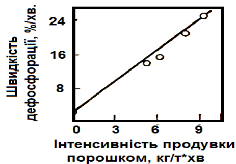
Рисунок 21 – Вплив інтенсивності продувки порошком на швидкість дефосфорації
