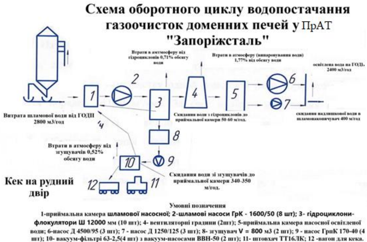
Рисунок 1.10 – Схема оборотного циклу водопостачання газоочисток доменних печей
