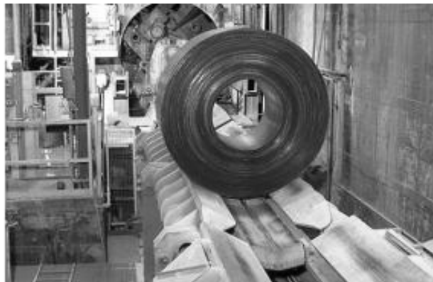
Рисунок 1.5 – Гарячекатаний рулон з межею плинності до 1300 \text{ Н/мм}^2 , товщиною - 8 мм, температура змотування 115 \text{ }^\circ\text{C} .
