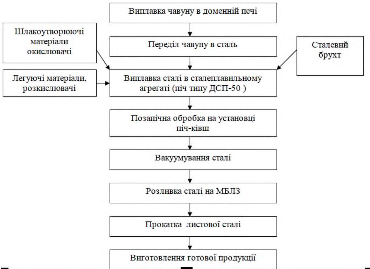
Рисунок 2.1 – Технологічна схема виробництва сталі марки X12МФ
