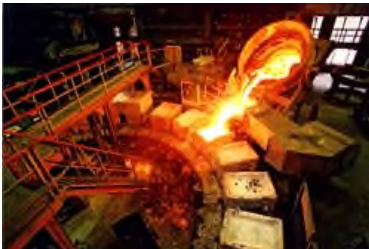
Рисунок 1.4 – Процес виплавки (а) та розливки (б) ФС90
