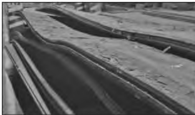
Рисунок 2.5 – Загальний вигляд сталі 30ХГСА після процесу відпалу
