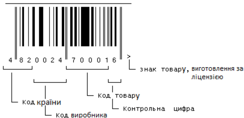
Рис. 84 – Приклад обчислення контрольної цифри штрих-коду
