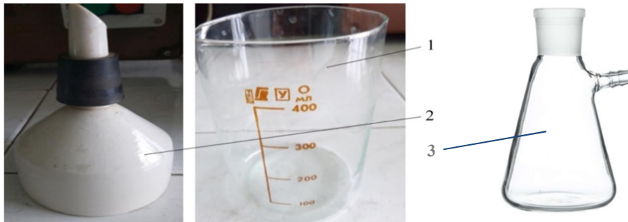
1 – фільтрувальна лійка Бюхнера; 2 – стакан скляний вимірювальний; 3 – колба Бунзена
