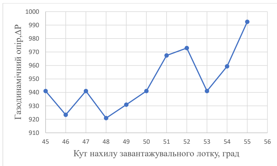
Рисунок 3.7 - Залежність газодинамічного опору від кута нахилу завантажувального лотку
