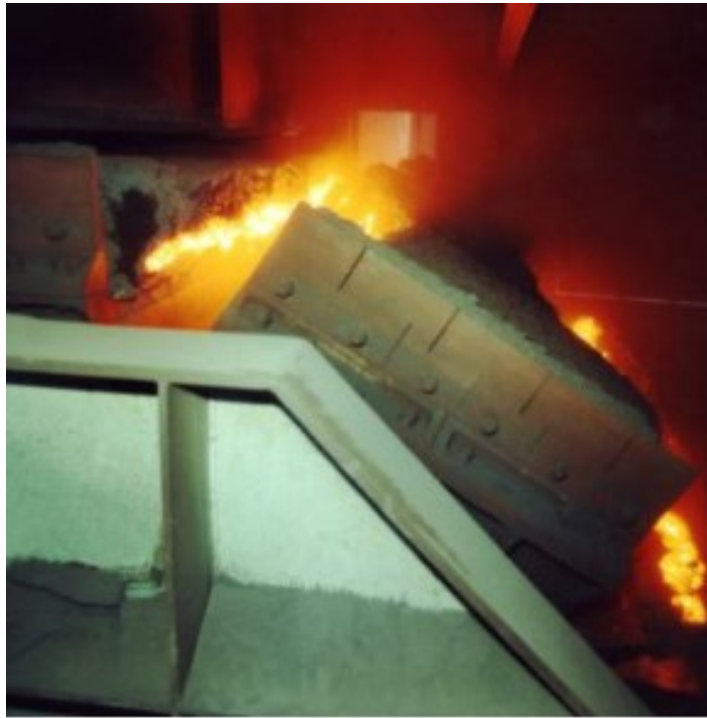
Рисунок 1.2 – Процес спікання агломерату
