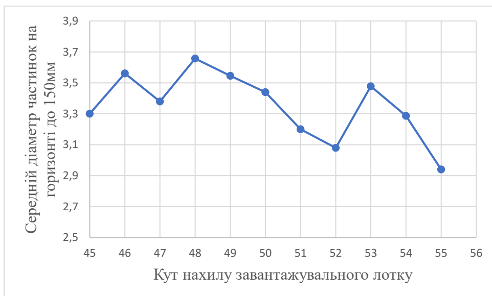
Рисунок 3.1 - Залежність середнього діаметру частинок шихти на першому горизонті в діапазоні від 0 м до 0,15 м від кута нахилу завантажувального лотка
