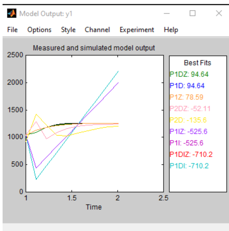
Рисунок 3.18– Оцінка відповідності передавальної функції при нагріві сталі 38Х2Н2М
