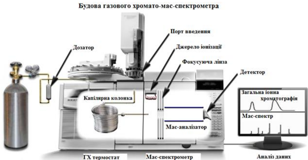
Рисунок 1.4 - Будова газового хромато-мас-спектрометра [15]
