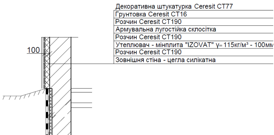
Рисунок 3.3 - Вузол утеплення фасаду
