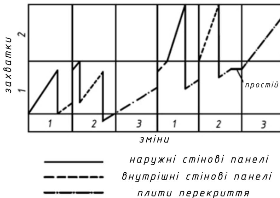
Рисунок 1.2 – Фрагмент циклограми монтажу конструкцій великопанельного житлового будинку в м. Запоріжжі
