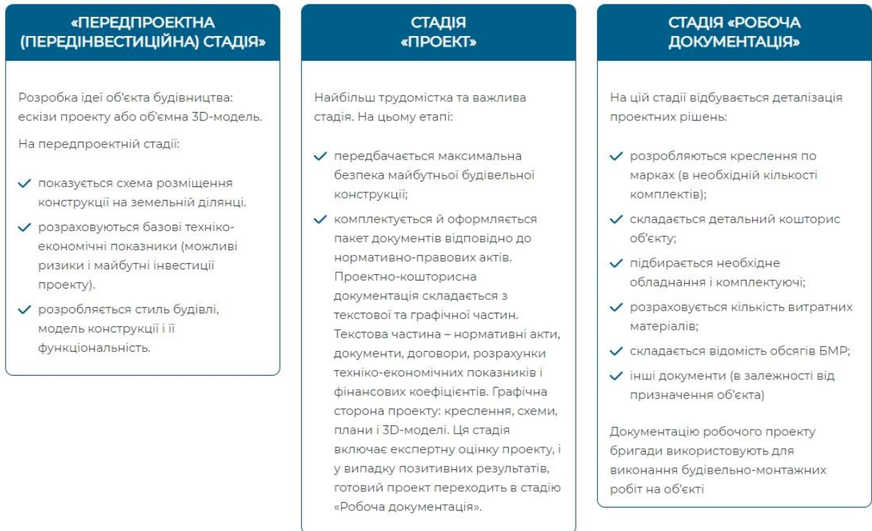
Рисунок 2.3 – Три основні стадії проектування будівельних об'єктів
