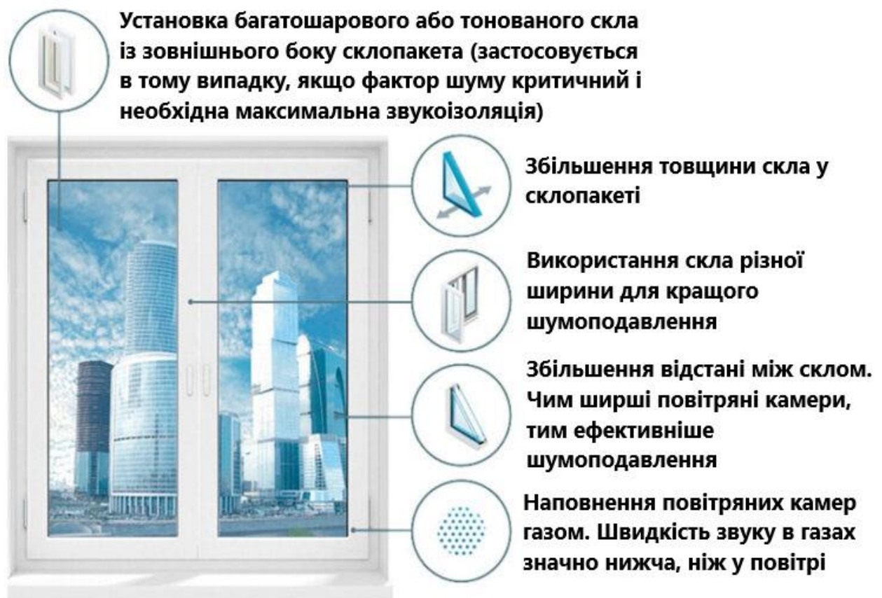
Рисунок 2.3 – Технології для підвищення шумоізоляції вікон
