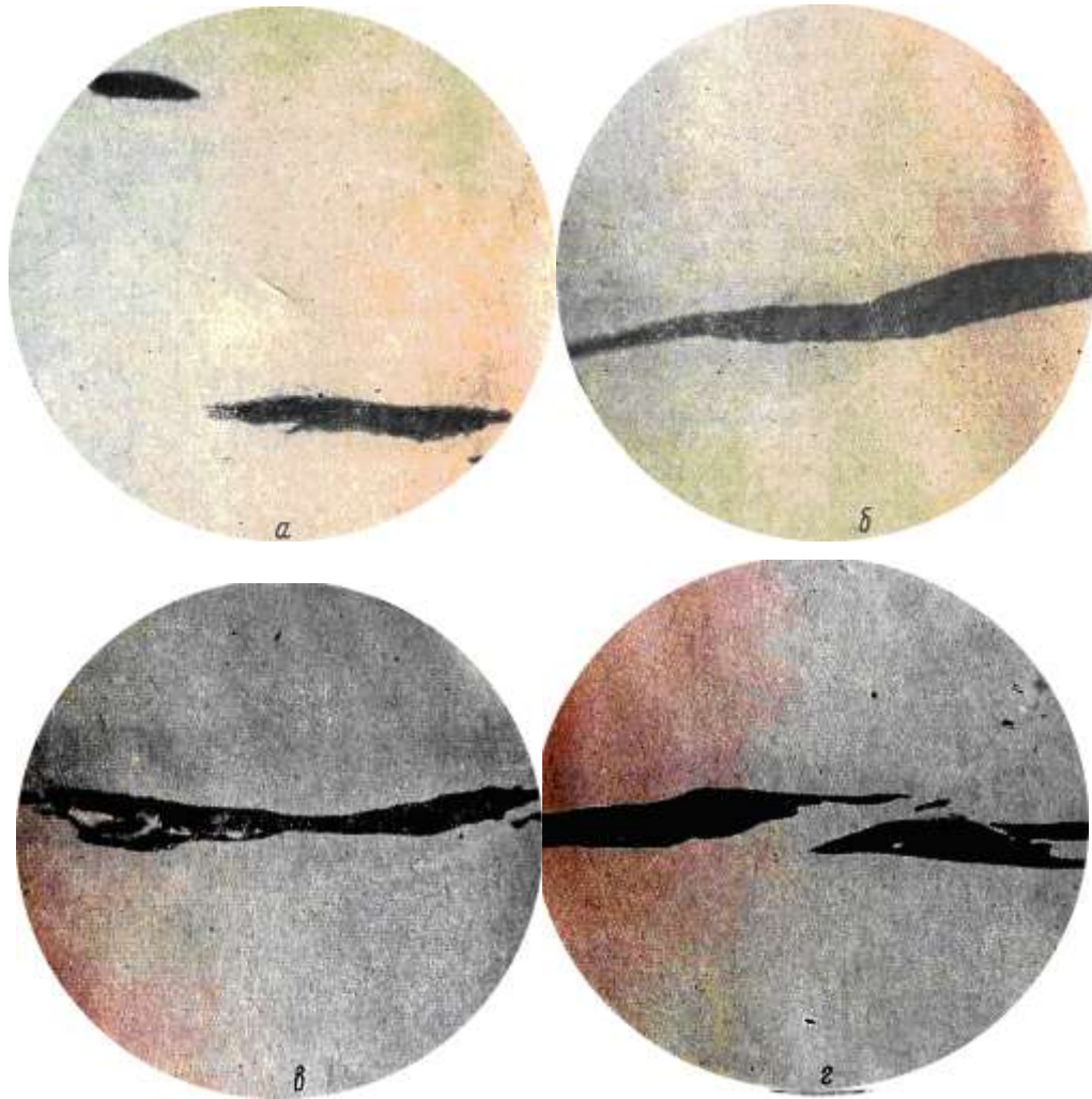
Рисунок 3.3 – Пластичні включення в шарикопідшипниковій сталі без кремнію і алюмінію: а - складні сульфіди; б - сульфіди і оксисульфіди; в - оксисилікати перехідного типу; г - включення з високим вмістом \text{MnO} і \text{FeO}
