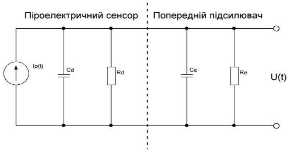
Рисунок 1.1 - Еквівалентна схема піроелектричного приймача і попереднього підсилювача
