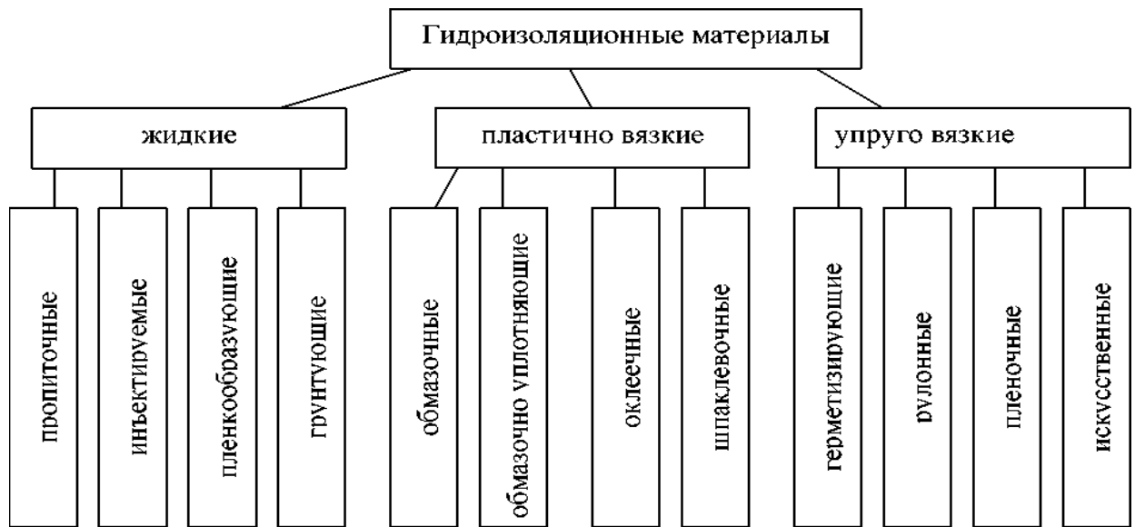
Рисунок 1.3 – Комбінована класифікація гідроізоляційних матеріалів
