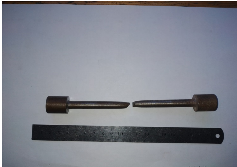
Рисунок 3.7 – Розірваний металевий зразок
