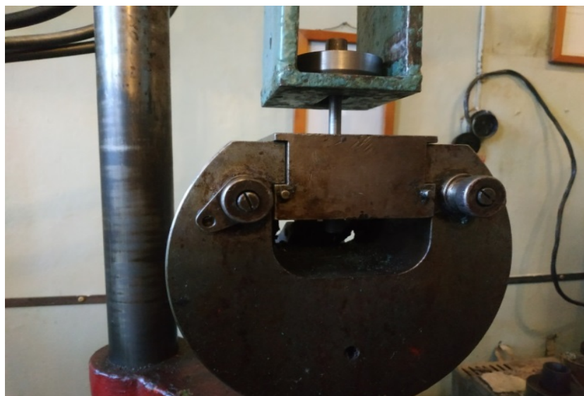
Рисунок 3.5 – Встановлення зразка в розривну машину
