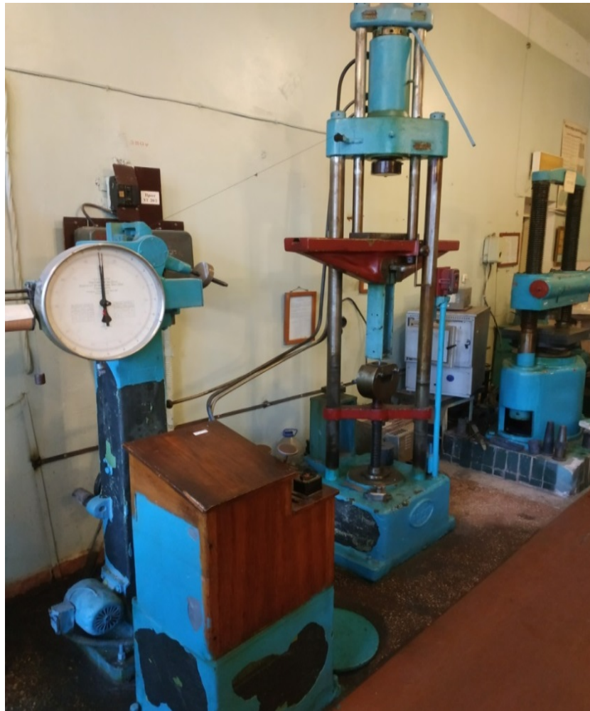
Рисунок 3.3 – Загальний вид розривної машини УГ-20
