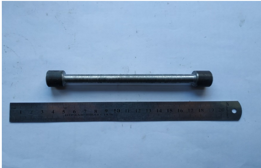
Рисунок 3.4 - Зразок для визначення механічних властивостей
