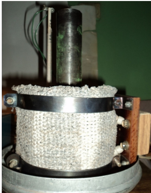
Рисунок 3.5 – Матриця для термохімічного пресування
