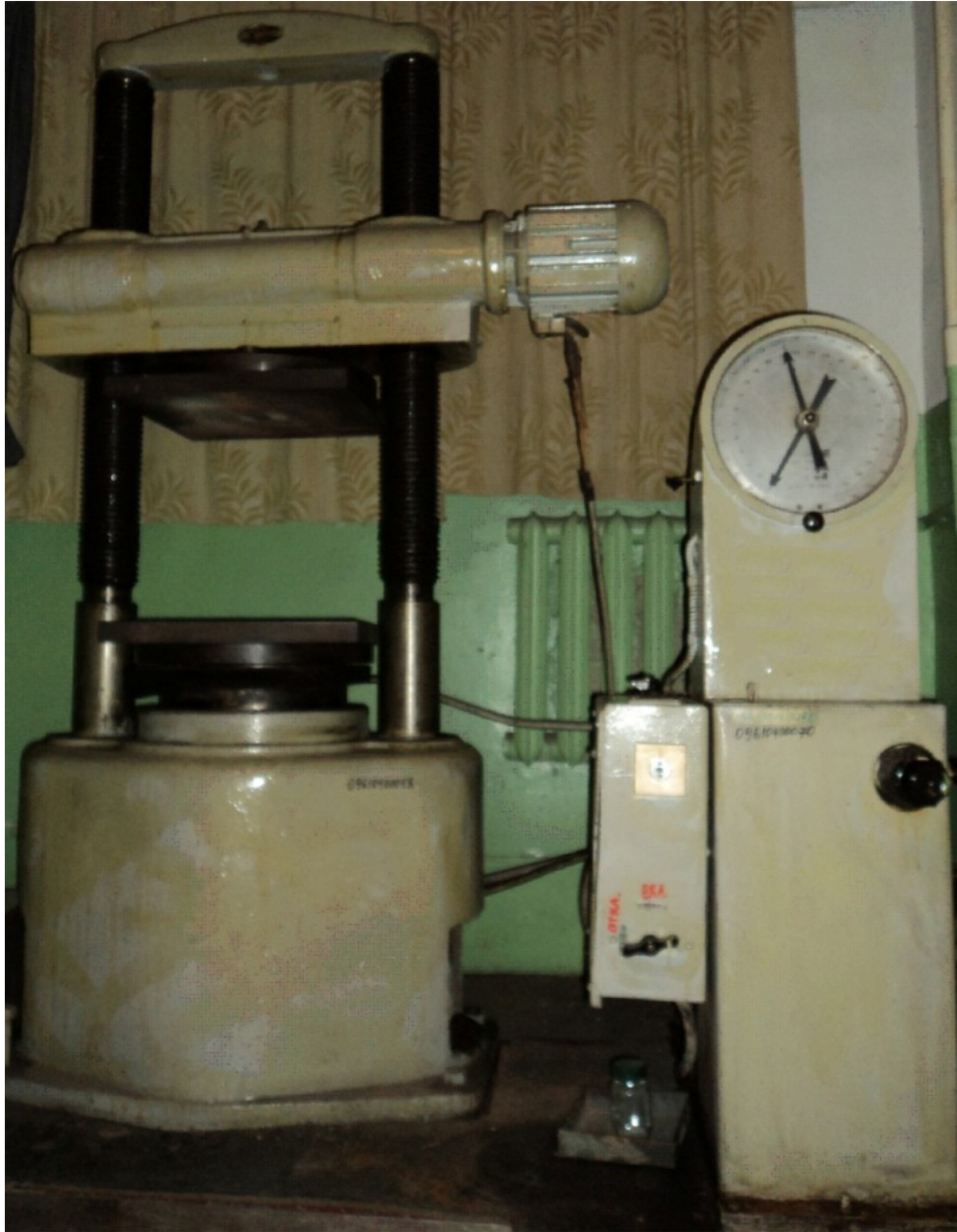
Рисунок 3.1 – Лабораторный прес ПСУ-125
