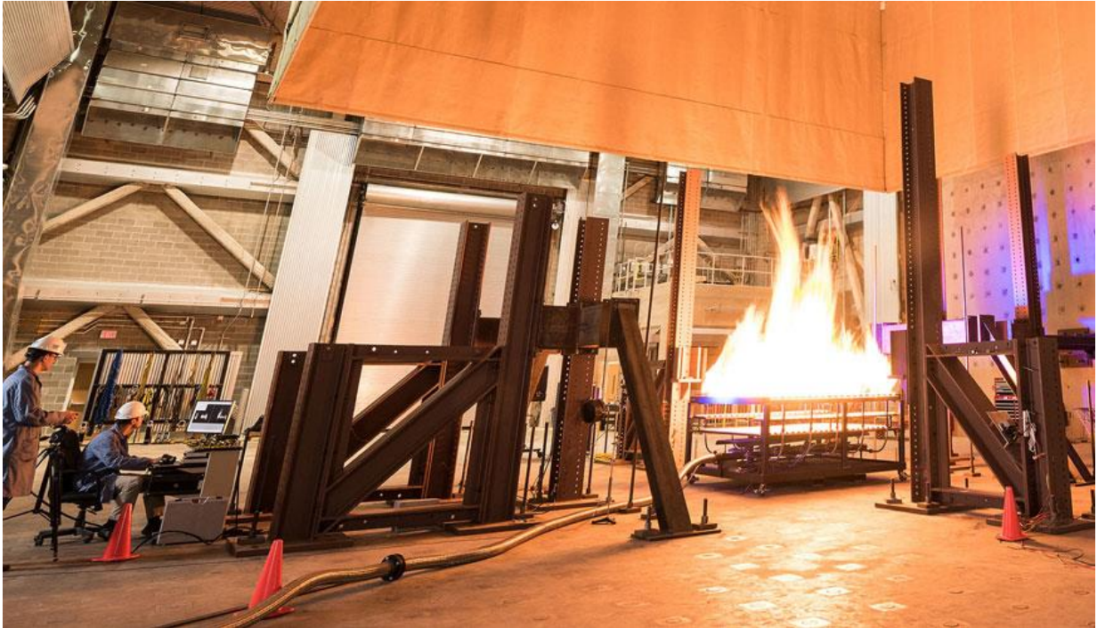
Рисунок 2.1 — Вогневі випробування дерев'яних панелей:
