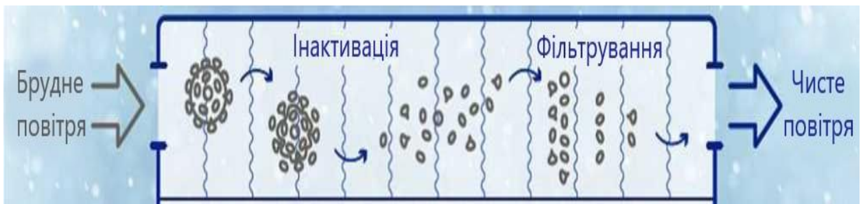
Рисунок 3.3 - Принцип очищення повітря на основі електропорації
