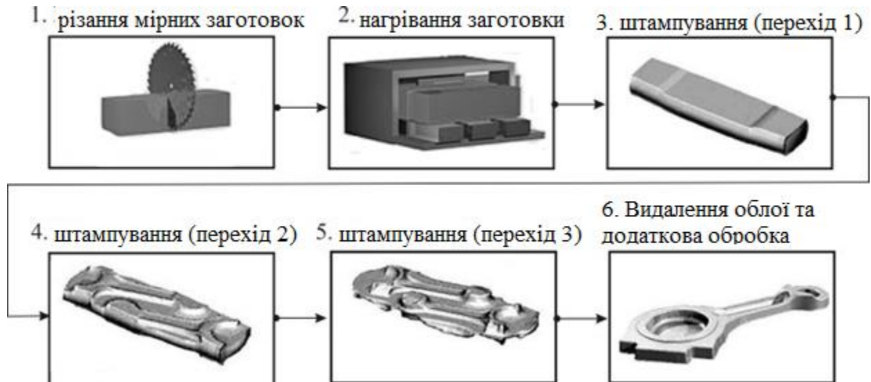
Рисунок 1.1 – Схема технологічного процесу виготовлення деталі типу «шатуни» методом гарячого об'ємного штампування
