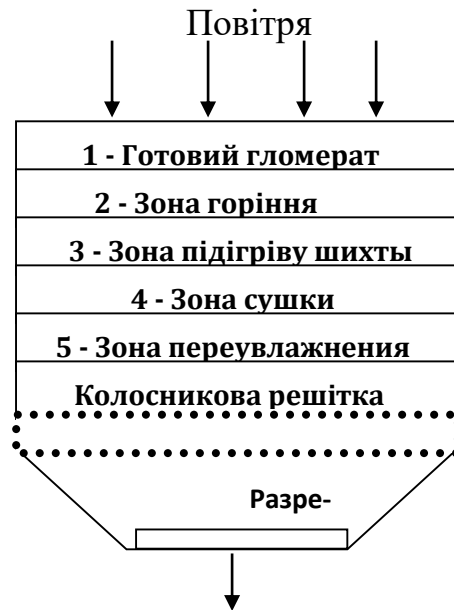
Рисунок 1.3 - Схема агломераційного процесу
