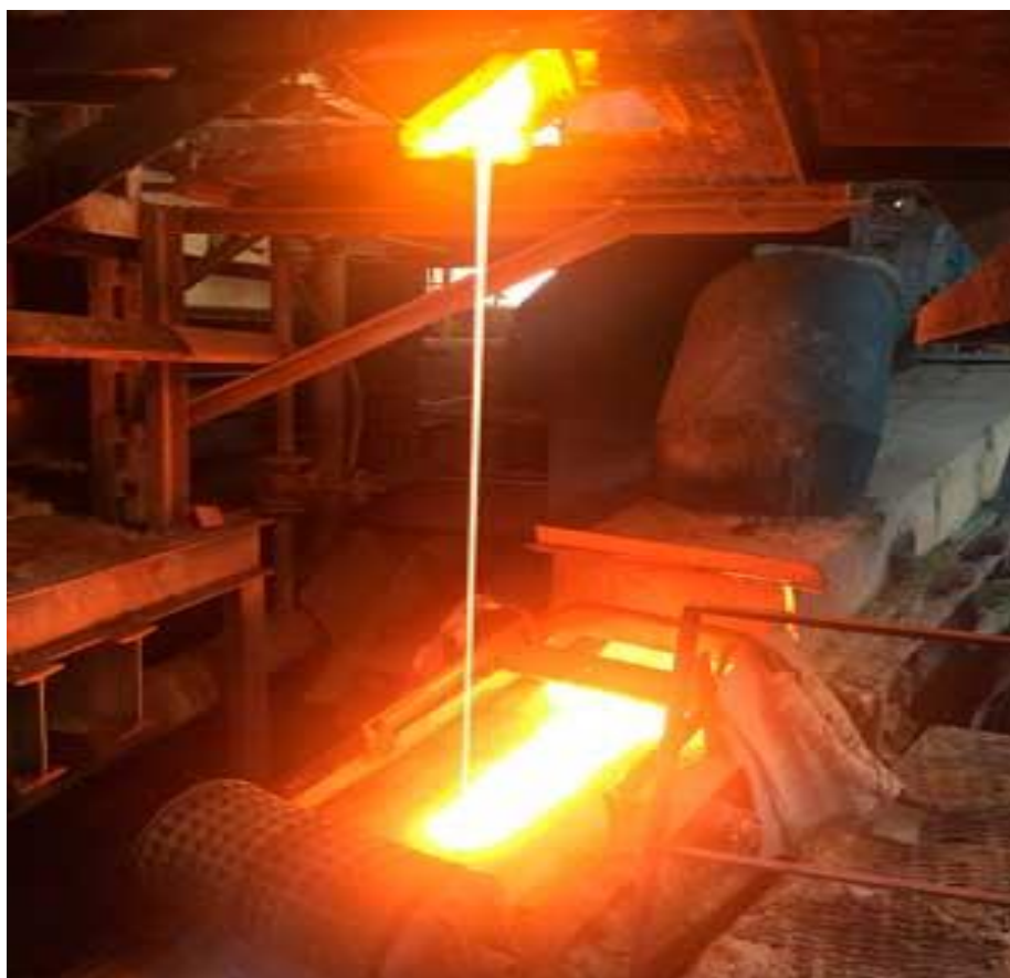
Рисунок 2.2 – Обладнання з виробництва зварювальних флюсів методом подвійного рафінування розплаву
