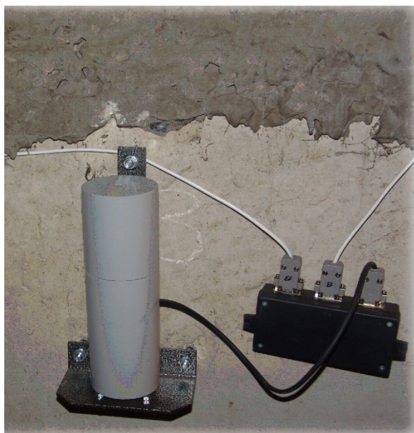
Рис. 4.1. Датчик контролю крену УІД
