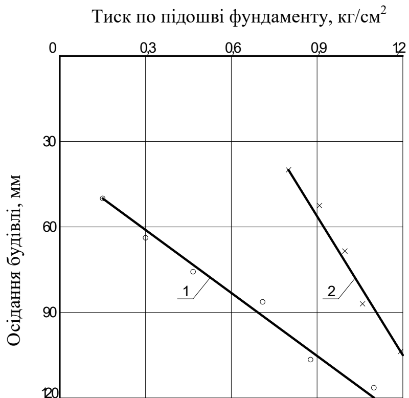
Рисунок 2.11 – Зміна осідань будівлі при зміні тиску в процесі вирівнювання:
