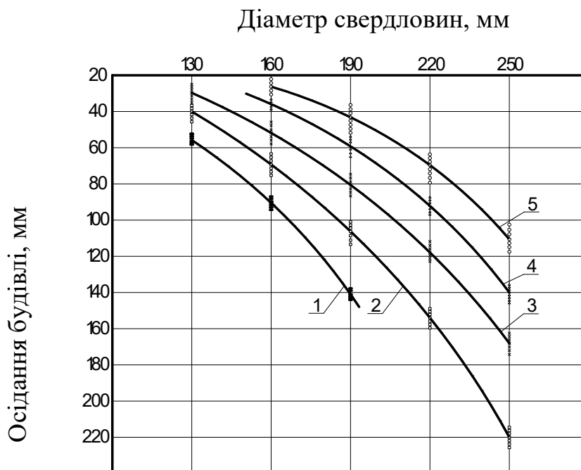
Рисунок 2.2 – Залежність осідань будівлі від зміни діаметрів свердловин для різних кроків t , мм: 1-250; 2-300; 3-350; 4-400; 5-450
