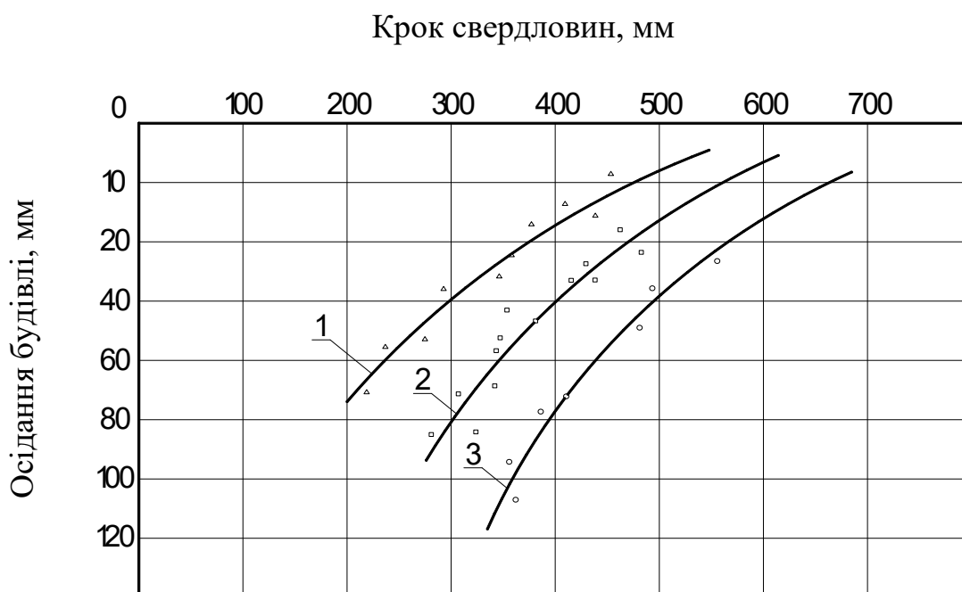
Рисунок 2.3 – Залежність осідань будівлі від зміни кроку свердловин для різних діаметрів d , мм: 1 - 130; 2 - 160; 3 - 190
