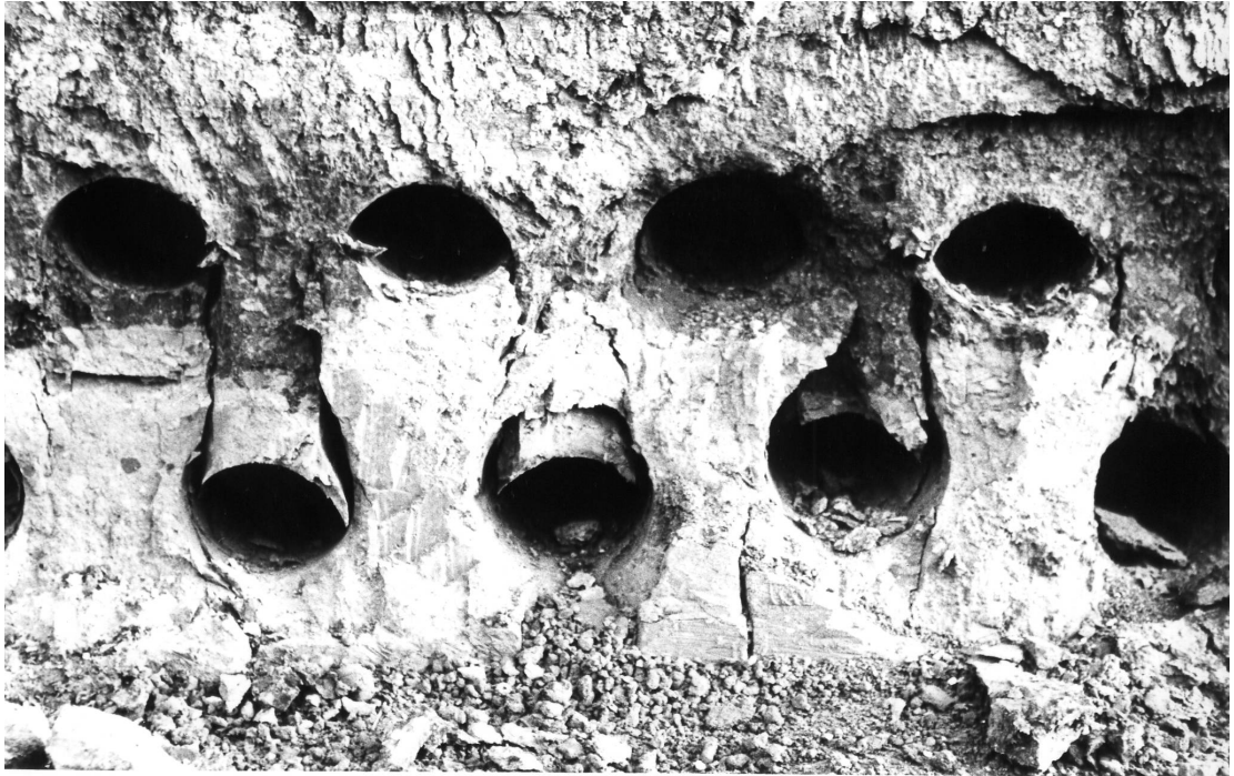
Рисунок 2.7 – Деформації свердловин і ціликів ґрунту між ними
