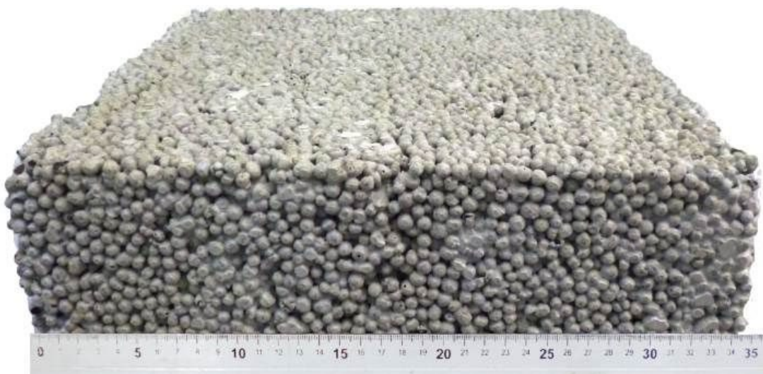
Рисунок 4.3 – Лабораторний зразок плити з легкого бетону
