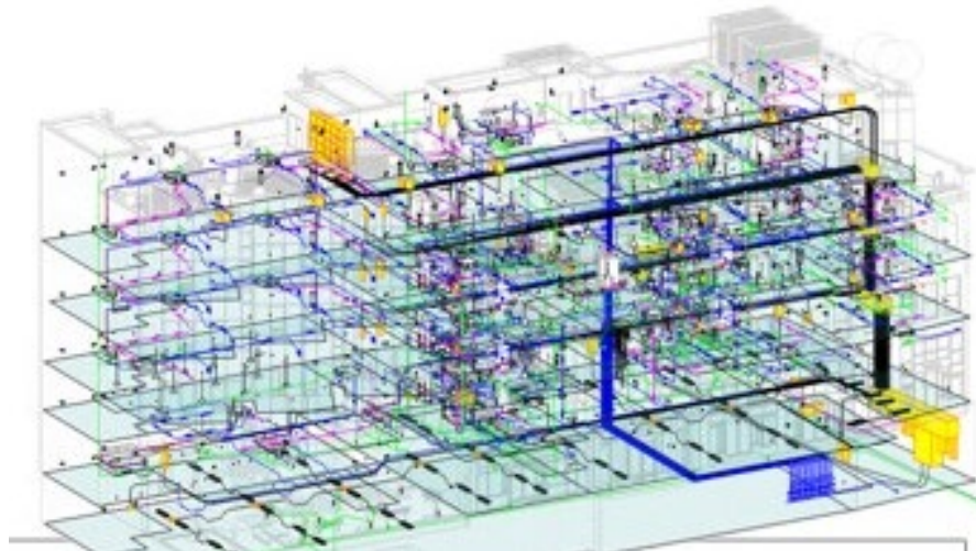
Рисунок 4.2 – Розташування опалювальних та кондиціонувальних пристроїв
