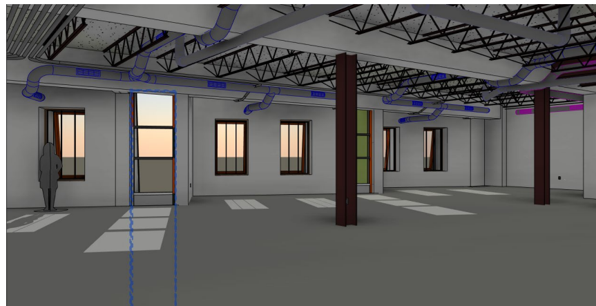
Рисунок 4.2.1 – Вентиляційних шахт та трубопроводів.
