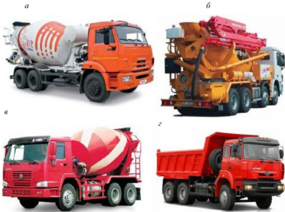
Рисунок 2.4 – Автомобільні засоби транспортування та подачі бетонної суміші: а - автобетонозмішувач; б - автобетоновоз з обладнанням - автобетоновоз;
