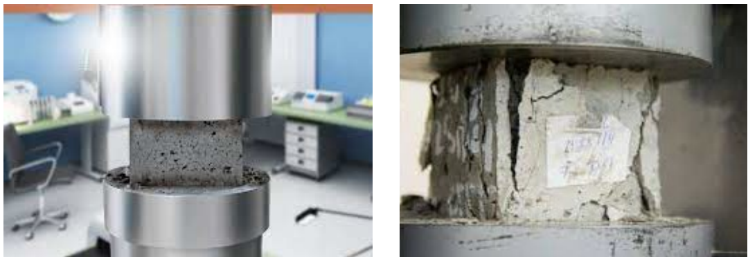
Рисунок 3.9 – Методи випробування бетону на міцність
