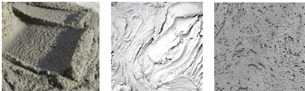
Рисунок 3.3 – Розчини М 25, вапняний розчин, бетонний розчин із збереженням рухливості до 2-х діб
