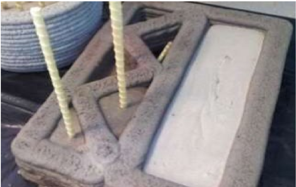
Рисунок 1.7 - Спосіб армування блоків
