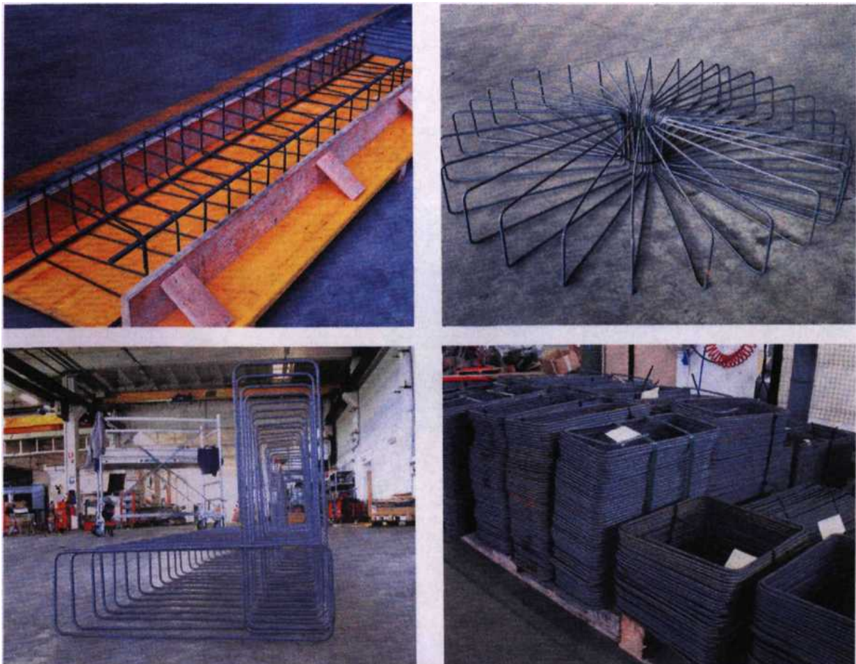
Рисунок 1.4 – Просторові безперервні спіралі, виготовлені за технологією «Брігех»
