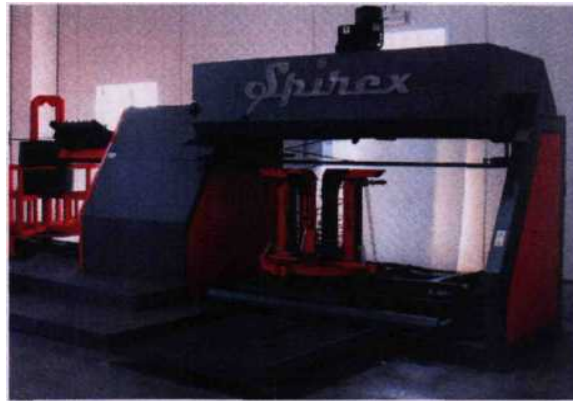
Рисунок 1.3 – Станок для виробництва безбезперервних хомутів
